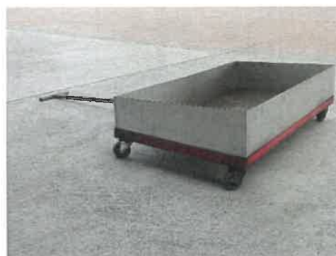
รูปที่ 2-4 ถาดเหล็กป้องกันการรั่วไหล
