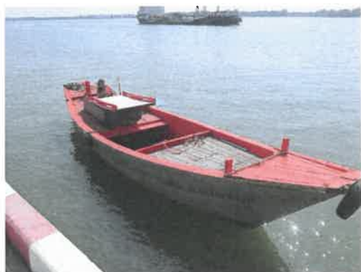
รูปที่ 2-1 เรือเล็กขนาดเครื่องยนต์ 24 แรงม้าใช้ในการลากบูม
