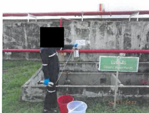
รูปที่ 2-28 การเก็บตัวอย่างน้ำทิ้งระบบบำบัดน้ำเสีย บริเวณบ่อบำบัด API
