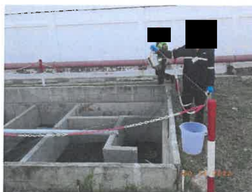
รูปที่ 2-26 การเก็บตัวอย่างน้ำทิ้งระบบบำบัดน้ำเสีย บริเวณบ่อบำบัด A
